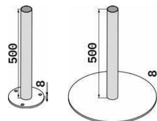
\*Pour mât longueur 2500 mm maximum et prise de vent inférieure à 1,80 m<sup>2</sup>.
