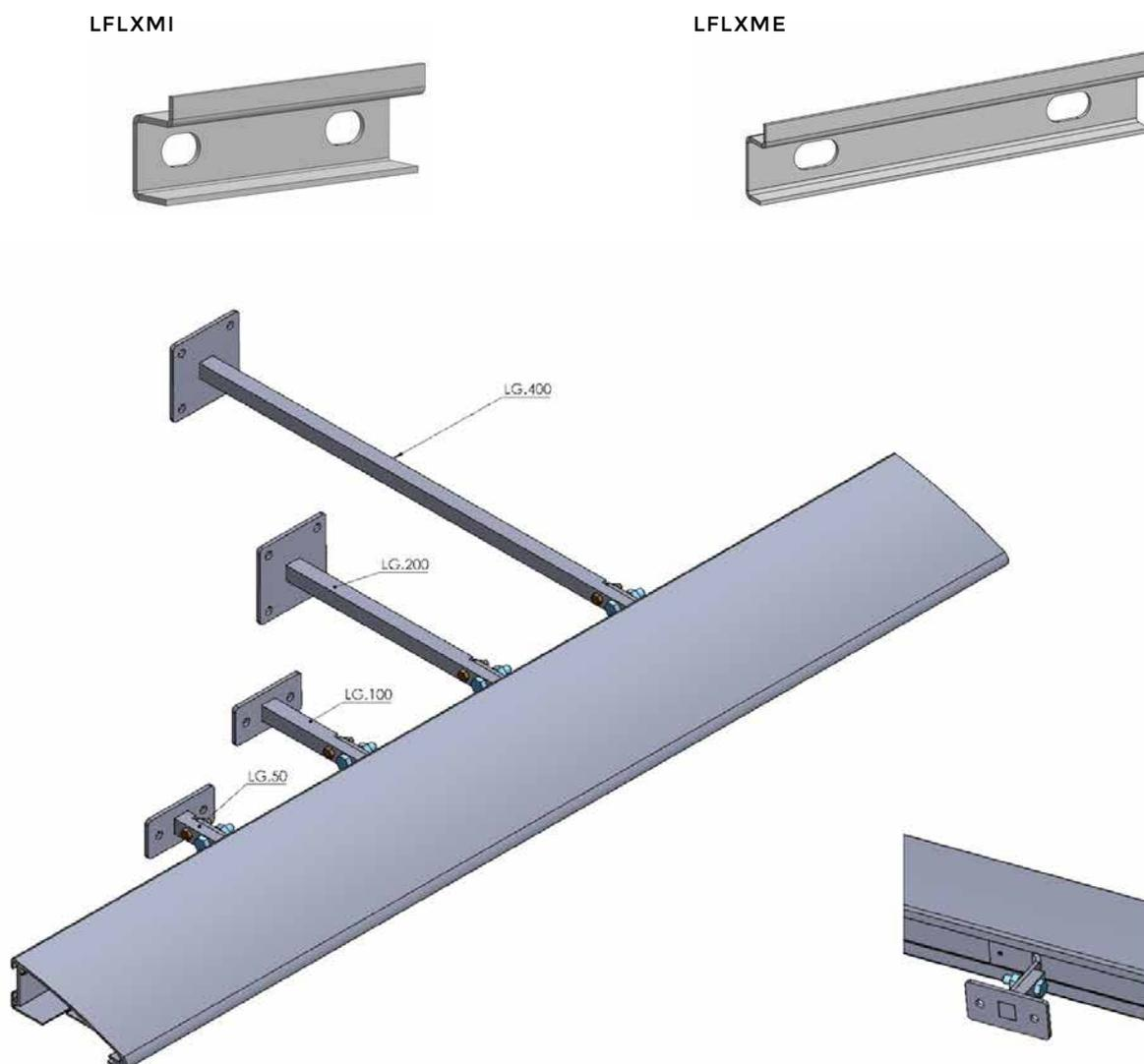
Pour une fixation optimale, pré-percer à 2 mm avec une vis autoforeuse de 2,9 mm.
